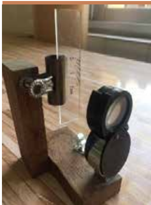
شکل ۳. خط کش مجهز به ذره بین برای اندازه گیری قطر قطره روغن
