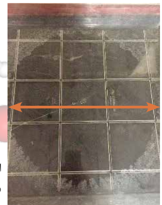
شکل ۴. دایره ایجاد شده در اثر پخش شدن یک قطره روغن روی سطح آب
